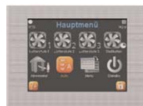
TFT dotykový panel: rozměry: 102x78x14mm
